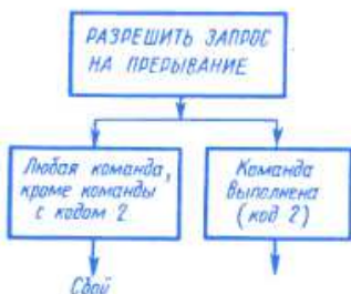
Рис. 4.8. Алгоритм выполнения БИФ команды РАЗРЕШИТЬ ЗАПРОС НА ПРЕРЫВАНИЕ
