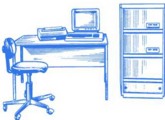
Рис. 3.4. МикроЭВМ СМ 1810, стоечное исполнение
