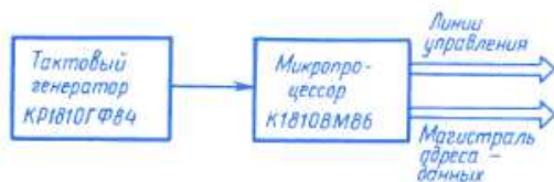
Рис. 1.2. Схема реализации минимального режима работы
