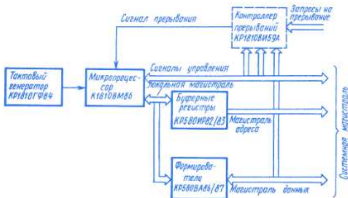
Рис. 1.3. Схема реализации минимального режима работы с разделением магистралей адреса — данных
