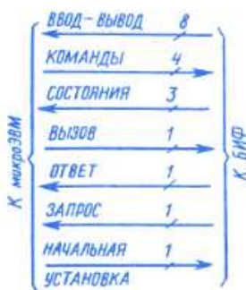
Рис. 4.2. Структура интерфейса микроЭВМ
