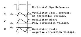
FIGURE 5-9 - HORIZONTAL OSCILLATOR FREQUENCY CORRECTION
