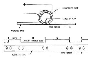
FIGURE 5-17 MAGNETIC TAPE RECORDING
