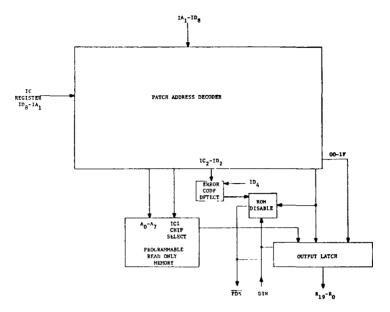
FIGURE 4-10 6547 SUPERPATCH BOARD
