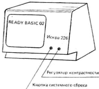
Рис. 2.1. Процессор микроЭВМ «Искра 226»
